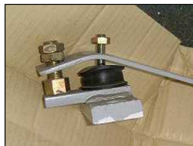
変形した防振ゴム部分
